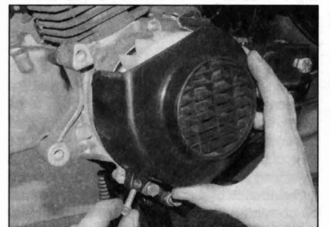
11.2 Remove the fan cowling . . .
